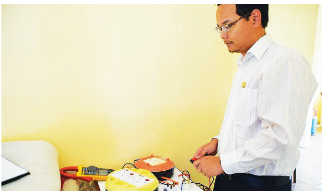
Pengujian penebatan dan rintangan pembumian bagi siasatan kes kemalangan maut.
