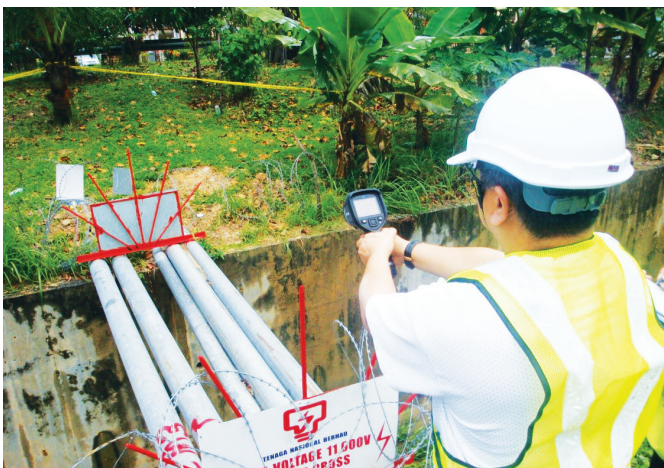
Pemeriksaan thermal dan Feeder Pillar di lokasi kes kemalangan maut.
